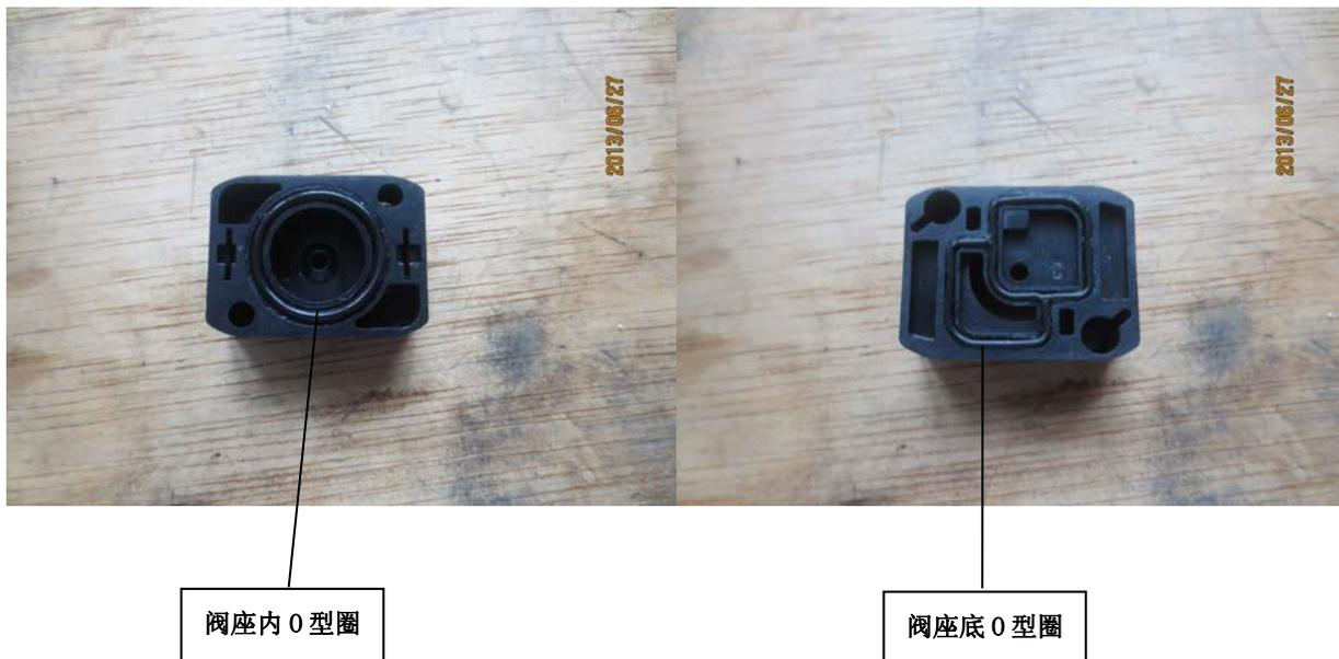
更换电磁阀时：拧松气路板上的两个固定螺丝，取下电磁阀，清理电磁阀的底座内外O型圈，抹上润滑阀芯的硅油在底座内外O型圈上。弹簧轻轻的拉一拉，压一压（弹簧位置小头向上、大头向里孔）。进气孔、出气孔位置对好，再安装在气路板上，拧紧两个固定螺丝即可。
